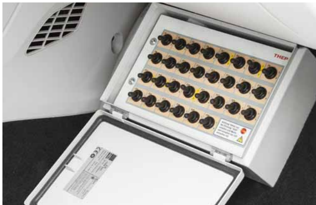
Fehlerbox (Antrieb / Batterie / Laden): 30 Schalter für 40 verschiedene Werkstattaufträge
