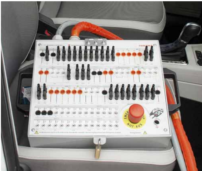
Breakout Box vorne: 75 x Niedervolt-Messpunkte (davon 28 mit Brückenstecker) / 17 x Hochvolt-Messpunkte / Not-Aus
