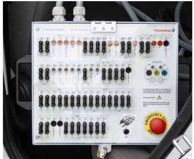
Breakout Box hinten: 53 x Niedervolt-Messpunkte (davon 41 mit Brückenstecker) / 10 x Hochvolt-Messpunkte / 5 x Ladestecker-Messpunkte / Not-Aus
